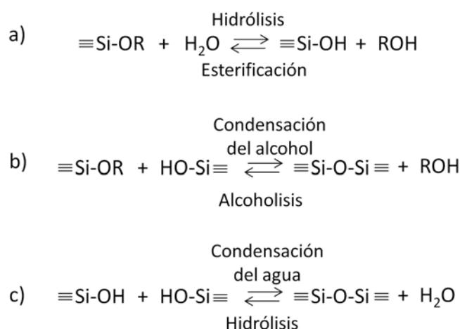
Figura 1.3: Esquema de las reacciones que tienen lugar en el proceso Sol-gel: a) hidrólisis, b) condensación del alcohol y c) condensación del agua. Figura adaptada de [1].
