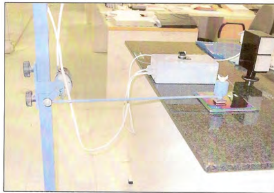
Figura 3.10: Imagen del dispositivo empleado para realizar los ensayos de resistencia a la abrasión.
