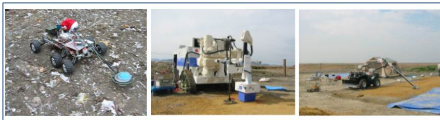
Fig. 3.- Concepto de locomoción para HUDEM ( Vienna University of Technology Division Intelligent Handling and Robotics, Viena, Austria ); y sistema para ensayar diversos detectores basados en GPR, MD, y el sistema dual ALIS ( Tohoku University, Sendai 980-8576, Japón ).
