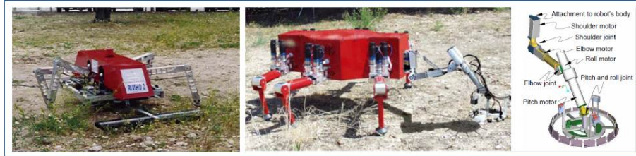
Fig. 4.- RIMHO 2 y SILO 6 (proyecto DYLEMA). Detalle del diseño del manipulador embarcado (Centro de Automática y Robótica CAR (CSIC-UPM). Ctra. Campo Real, Km. 0,200- La Poveda. 28500 Arganda del Rey, Madrid, Spain).
