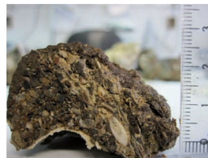
Fig.4.- Depósito formado por restos vegetales silicificados mezclados con terrígenos siliciclásticos.
