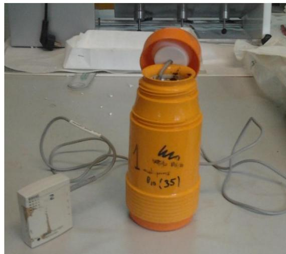
Foto 6. Vaso Dewar conectado a un Data logger
