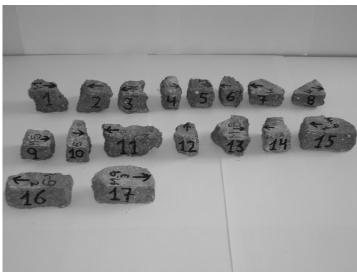
Figura 7. Ensayos de aplicación de productos consolidantes sobre ladrillo macizo. Bóvedas de sótano de la Casa de la Panadería en la Plaza Mayor de Madrid.
