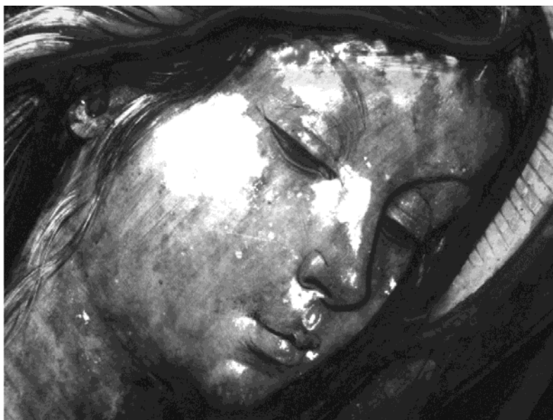
Figura 9. Imagen de un fragmento de vidriera con pérdida parcial de grisalla de sombreado insuficientemente densificada o de pintura fría.
