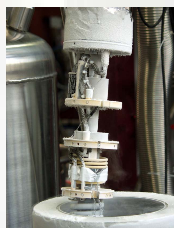
Detalle de un refrigerador de dilución.
