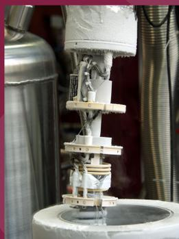
Detalle de un refrigerador de dilución.
