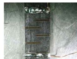
◀ Cortes con láser sobre un superconductor texturado para formar meandros para un limitador resistivo de corriente.
