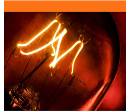
Hilo de una bombilla de incandescencia calentado al rojo vivo por el paso de corriente. Foto de John C. Shaw.
