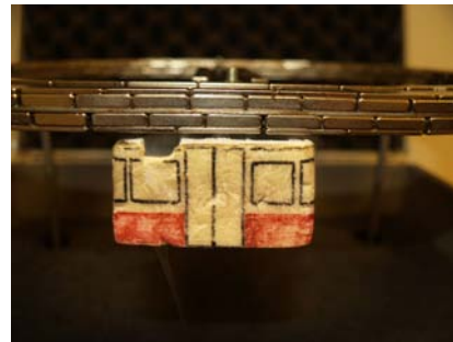
Kit de levitación desarrollado por el ICMA mostrando la levitación y la suspensión de un superconductor en un campo magnético.
