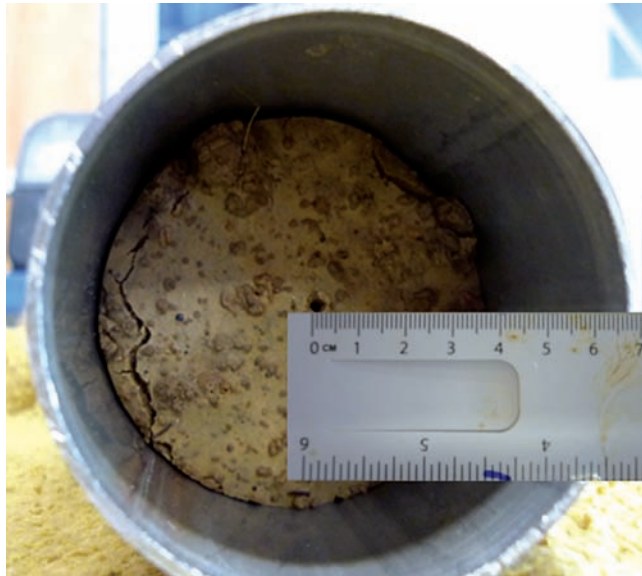
Figura 6. Agujero final después de la prueba de laboratorio.
