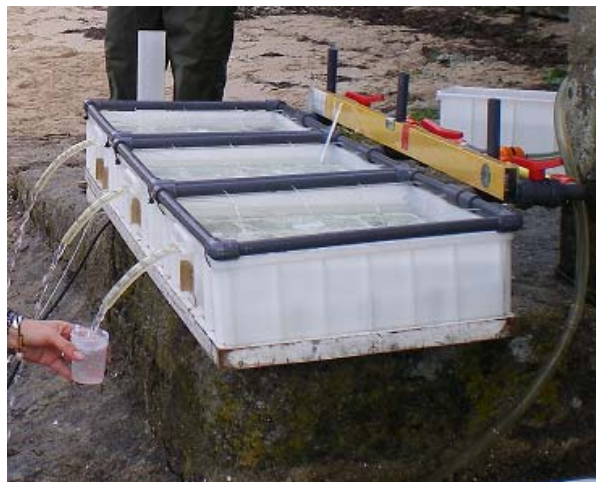
Figura 4. Diseño experimental para la estimación de las tasas fisiológicas de los mitílicos Mytilus galloprovincialis y Xenostrobus securis bajo condiciones naturales en la Praia de Xoutoxuste (Ensenada de San Simón).
