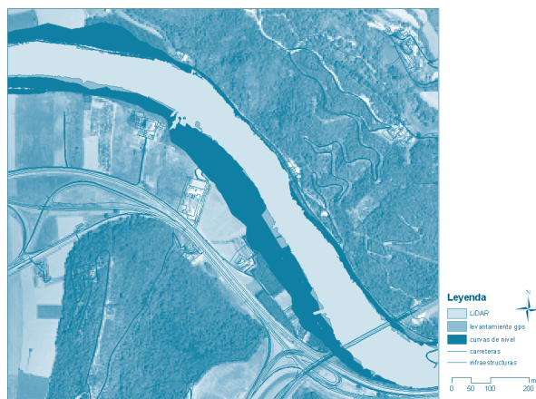
Figura 8. Gráficos con las delineaciones de las áreas inundadas para un caudal de 1000 \text{ m}^3\text{s}^{-1} en función de la cartografía fuente sobre la ortoimagen.
