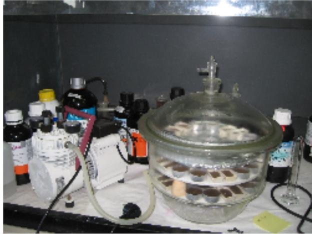
**Imagen 14.- Desecador de vacío. Proceso de fumigación.**
