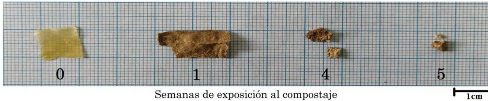
**Figura 3.** Fotografía del material biobasado en diferentes etapas de degradación.
