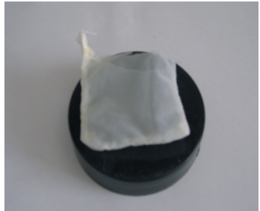
Figura 5. Contenedor de resina utilizado en los experimentos in situ para la adsorción de toxinas lipofílicas disueltas en el agua de mar: Bolsita confeccionada con red de 70 \mu\text{m} de tamaño de trama y dimensiones de 60x60 mm.
