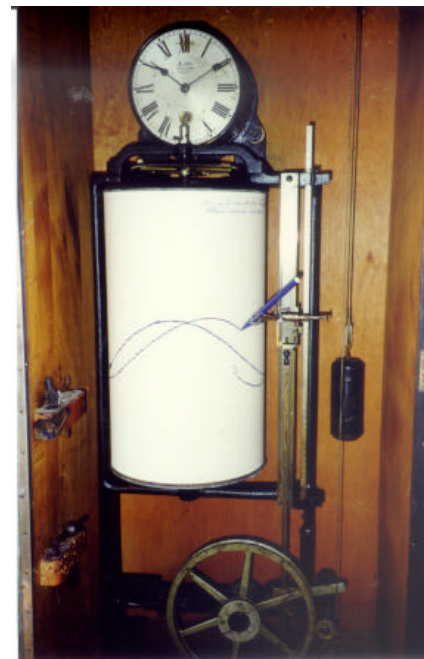
Figura 2 – Mareógrafo de flotador. (Tide-gauge)
