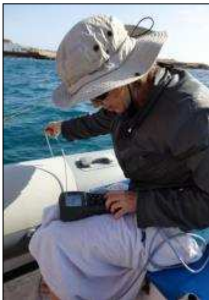
Campañas de muestreo: registro con sonda multiparamétrica, muestreos de agua y conservación a bordo.
