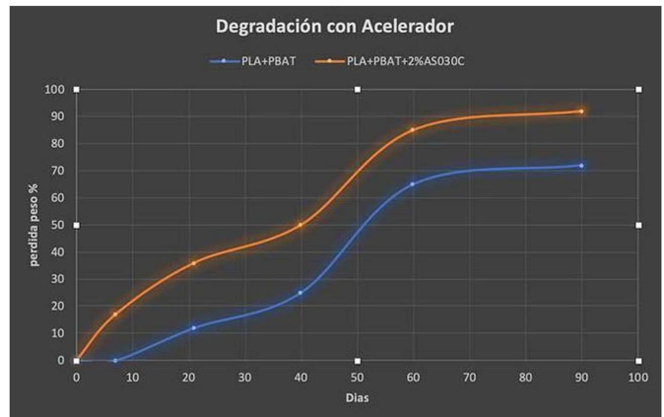
**Figura 2.** Pérdida de peso en función de los días de compostaje de dos muestras poliméricas de PLA/PBAT, una de ellas sin aditivo y otra con aditivo AS030C.
