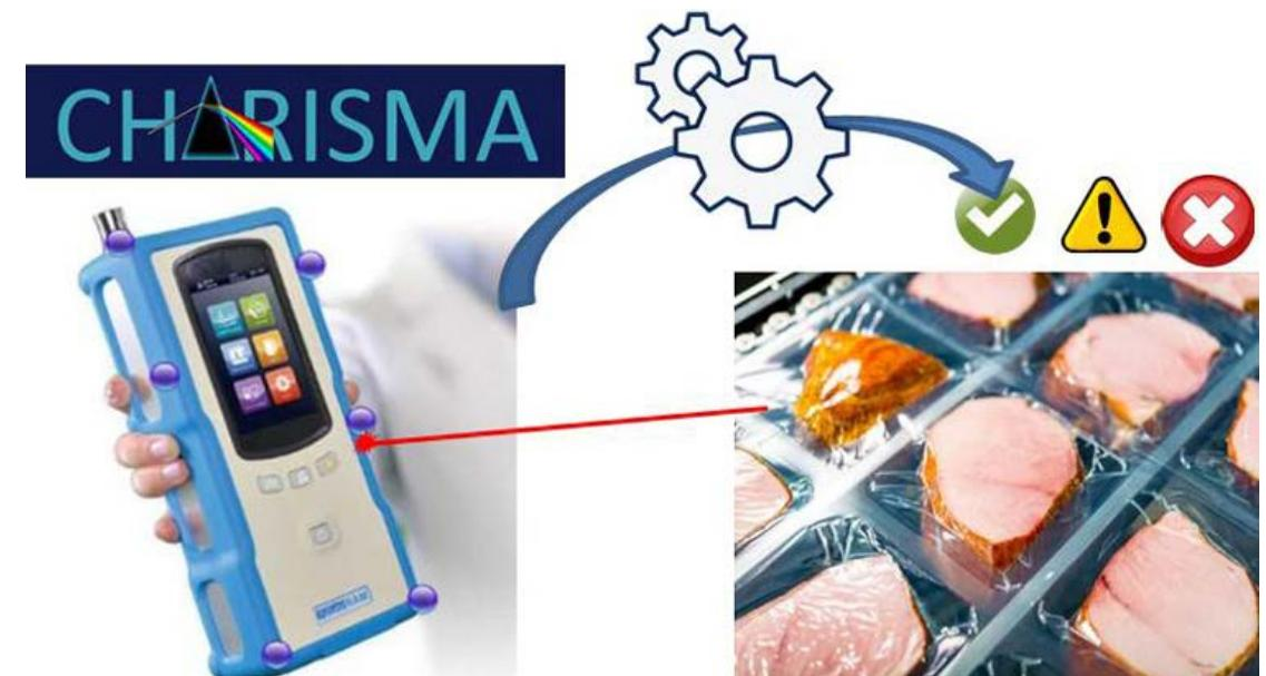
**Figura 1.** Concepto del proyecto CHARISMA aplicado al envasado de alimentos cuyo objetivo es monitorizar a través de un instrumento Raman portable la conservación y calidad del alimento envasado.
