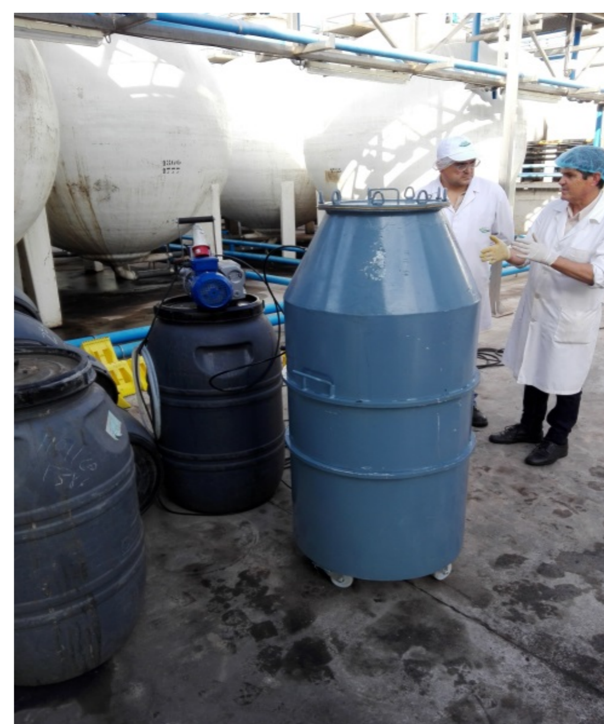
Figura 1. Equipo de impregnación al vacío empleado para las experiencias.
