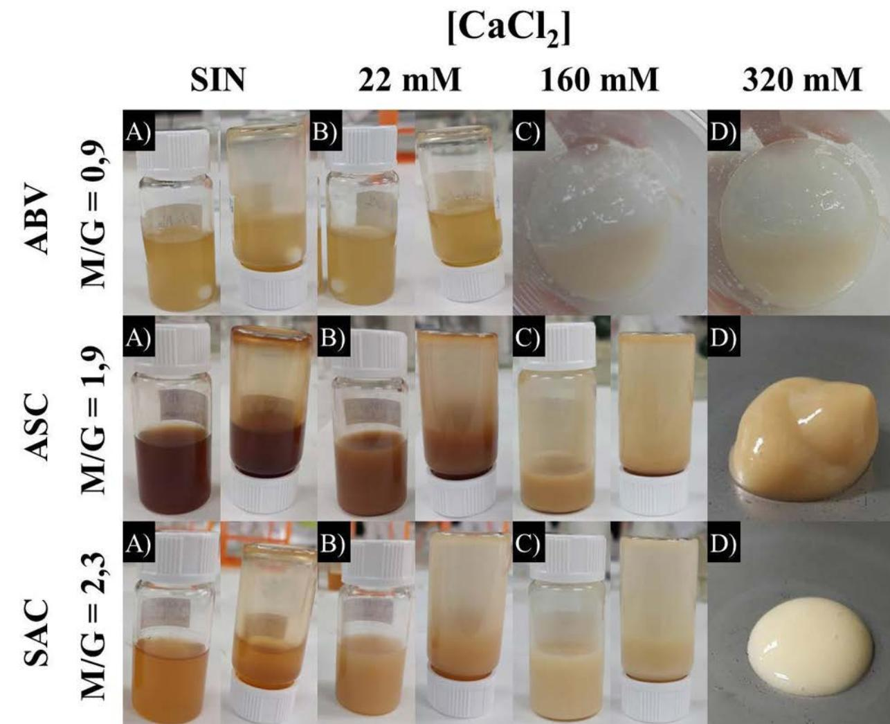
**Figura 2.** Biotintas de alginato al 8% (p/v) a diferentes concentraciones de CaCl<sub>2</sub>. A) sin CaCl<sub>2</sub>, B) 22 mM, C) 160 mM y D) 320 mM.
