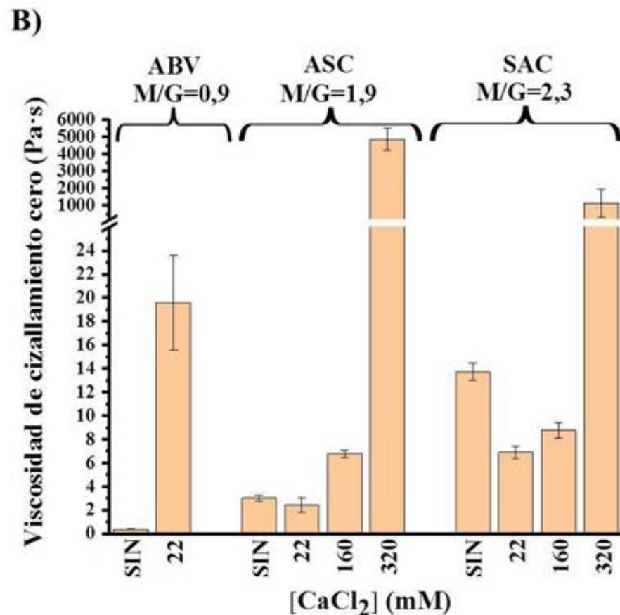
**Figura 3.** A) Ensayo de flujo; B) Gráfico de barras con los valores de viscosidad a cizallamiento cero,  $\eta_0$ , para las diferentes biotintas en función de la concentración de cloruro cálcico.
