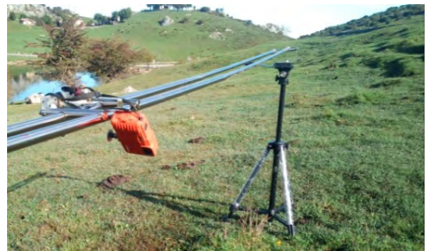
Fig. 4. Cámara de fotos digital, inclinada 45º instalada sobre perfilómetro de doble carril, en el reguero 2, en la ladera oriental del lago Enol.
