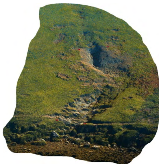
Fig. 6. Vista 3D de la nube de puntos obtenidos por restitución fotogramétrica a partir de imágenes tomadas con dron en el tramo final del reguero 1, en la ladera oriental del lago Enol. Fig. 6. 3D view of the cloud of points obtained by photogrammetric restitution from images taken with drone in the final reach of gully 1, on the eastern slope of Lake Enol.
