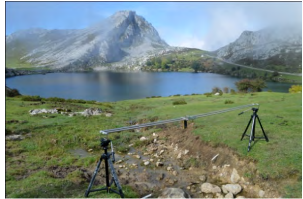
Fig. 3. Perfilómetro de doble carril con el distanciómetro láser instalado sobre una sección transversal del reguero 1, en la ladera oriental del lago Enol.
