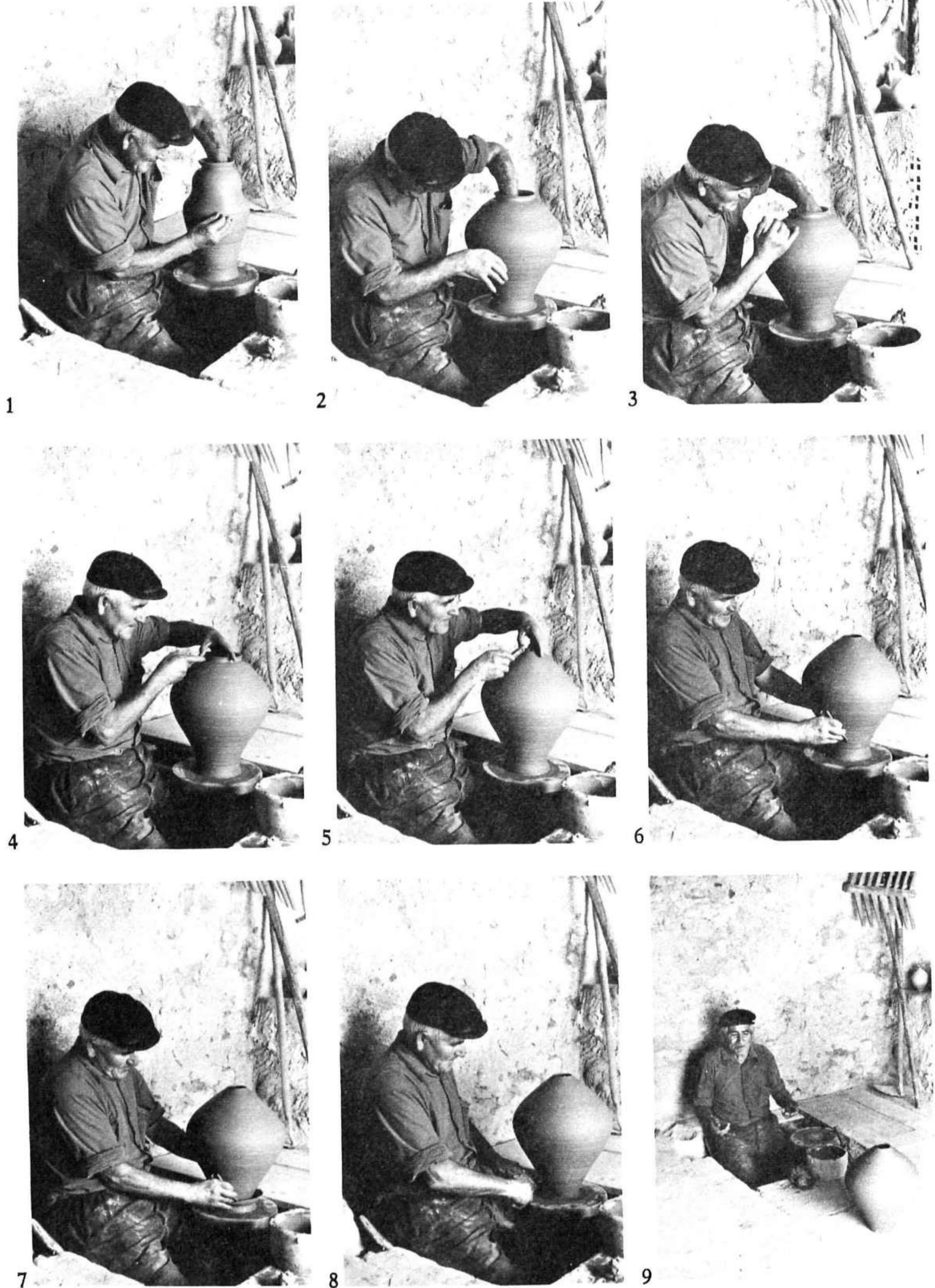
Lámina IV: Modelado de un cántaro, Cullar Baza (cont.) (1. Segunda tirada, con la yema de los dedos; 2. Tercera tirada; 3. Perfilando los hombros; 4. Estrechando el cuello con el dedo; 5. Estrechando el cuello con la caña; 6 y 7. Recortando el culo; 8. Retirando el barro sobrante del recorte; 9. El cuerpo de la pieza ya fuera del torno.
