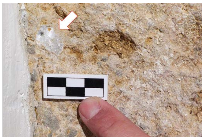
Fig. 8. Pilar occidental de la arquería norte, donde se recoge la muestra E9. Se señala la oquedad tapizada de cristales de calcita, empleo de caliza margosa con fracción detrítica
