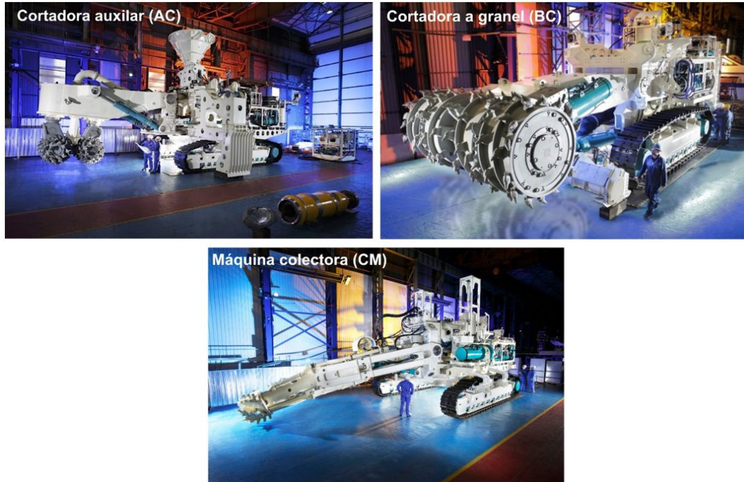
Figura 15. Cortadoras y recolectoras submarinas propiedad de la empresa Nautilus Minerals (Fuente: Nautilus Minerals ).
