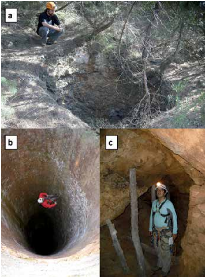
Figura 2. (a) Fotografía mostrando un colapso de un pilar corona de un minado somero en la zona de S'Argentera. Fotografías del interior de las minas de S'Argentera: (b), descenso mediante técnicas espeleológicas a las labores subterráneas, a través de un pozo maestro de 1900; (c) Labores en tajo largo entibadas con madera de sabina y pedriza de relleno, para sujetar zonas antiguas deszafadas. Posibles trabajos de la década de 1860-1870 (Campaña de exploración de junio de 2010).
