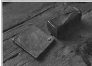
fig. 3 - Geste de pression avec le poids du marteau percutant la pastille de cuivre et écrasant les paillettes d'or plus ou moins agglomérées se trouvant en dessous (en haut) ; aplatissement de l'ébauche de feuille obtenue.
