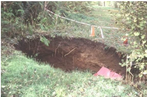
Figura 28. Vista lateral del menor de los colapsos de la Cuesta de Santa Lucía.
