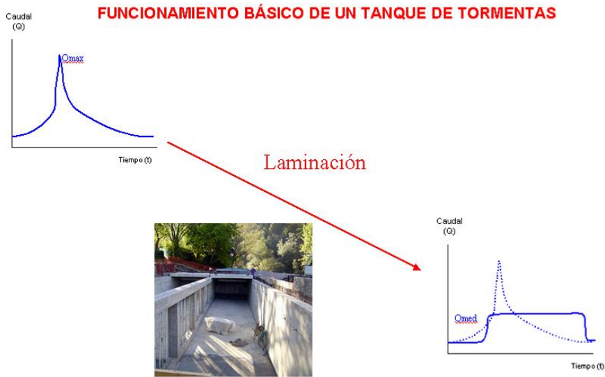
Figura 84. Funcionamiento de un tanque de tormentas, laminando el caudal punta del hidrograma de avenida súbita y transformando el pico en una meseta de caudal que se prolonga en el tiempo. Vista del interior del tanque de tormentas bajo la pradera de San Marcos.
