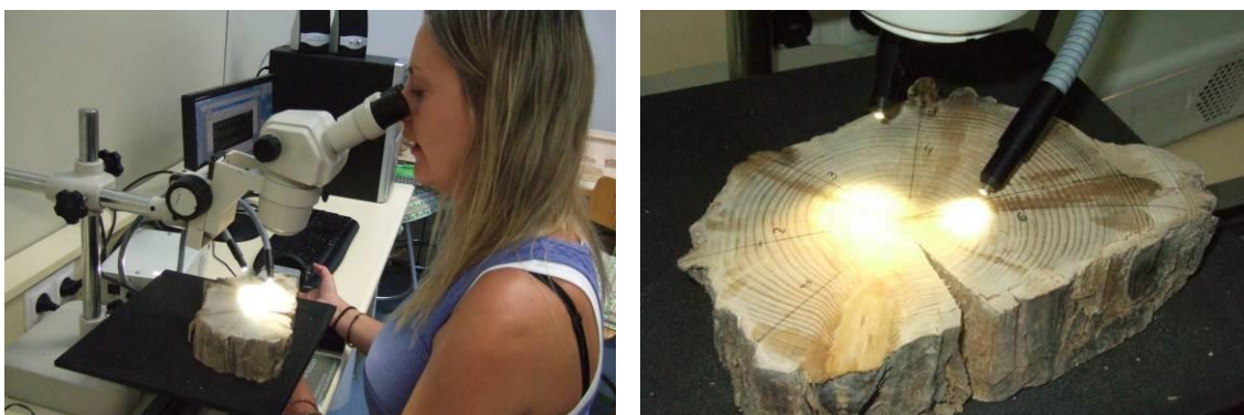
Figura 49. Conteo y medición de la anchura de los anillos en varios radios de una misma rodaja con el empleo de la mesa de medición LINTAB™. Fuente: Génova et al. (2011).
