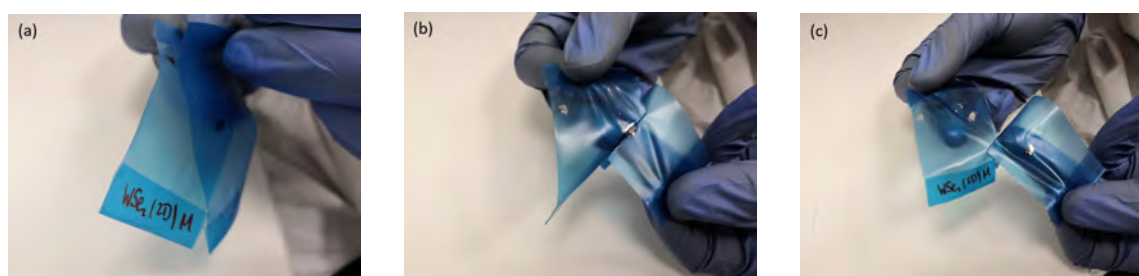
(a) Máster de WSe_2 en contacto con un trozo de 'blue tape'
