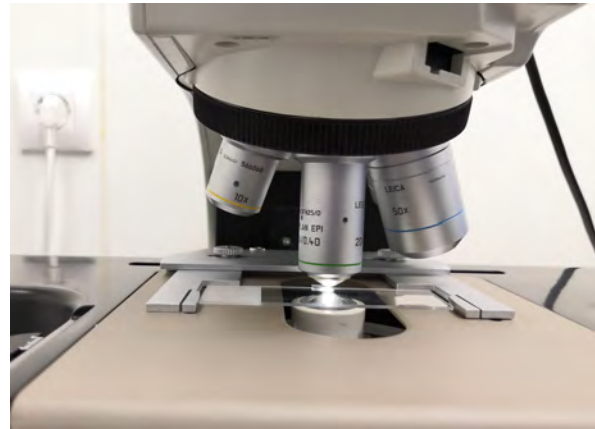
(b) Aumentos del microscopio enfocando una muestra exfoliada de WSe_2 sobre PDMS
