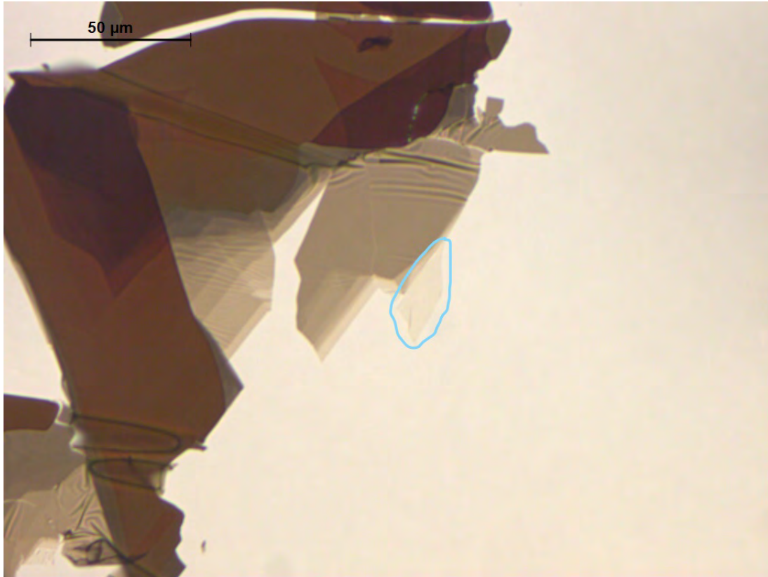
Figura 36: Cristal de WSe_2 depositado sobre PDMS. Imagen tomada con el microscopio óptico Leica en modo transmisión con un aumento de 50x.
