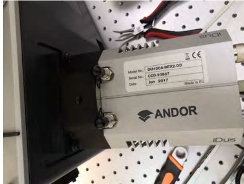
Figura 26: Cámara conectada al espectrómetro Andor Kymera 328i
