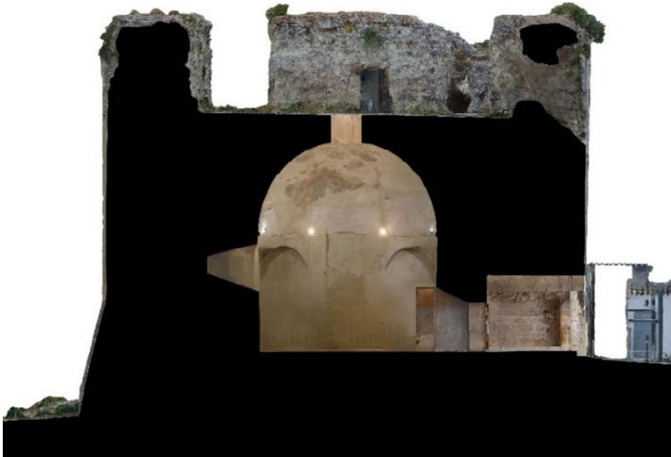
Figura 5. Ortofotografía obtenida por procedimientos fotogramétricos de la sección vista hacia el sureste de la Torre Gorda del Castillo de Morón de la Frontera (20 de septiembre de 2019). Autor: Luis García Pulido
