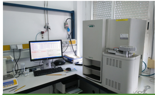
Elemental Analyzer: Leco TruSpec CN
