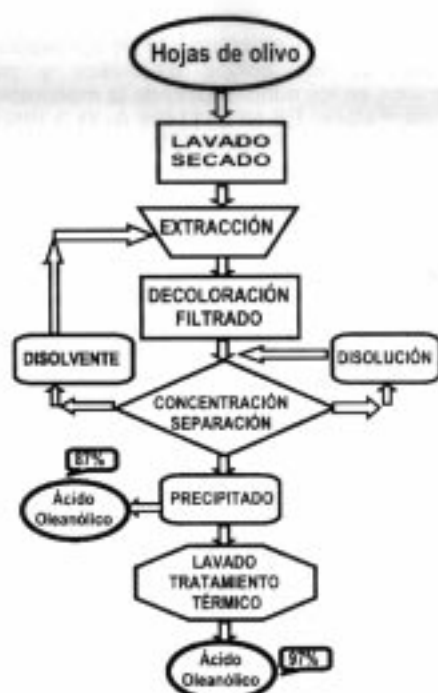
Figura 2 Esquema del método de obtención del ácido oleonólico de las hojas del olivo.
