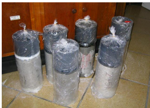
Figura 3: Ensayo natural de difusión de cloruros.
