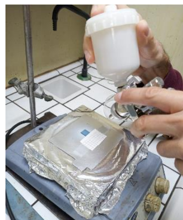
Figura 12. Pulverizado óxido de titanio sobre de nanotubos.
