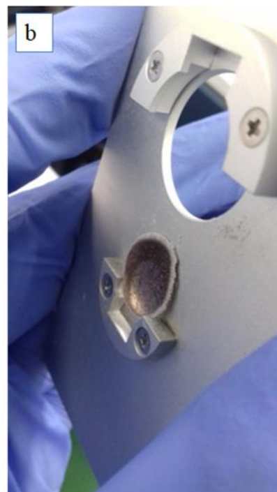
Figura 11. a) Equipo de espectroscopía IR Jasco System; b) Pastilla de muestra con KBr en el soporte para medir su espectro IR (Fuente propia).
