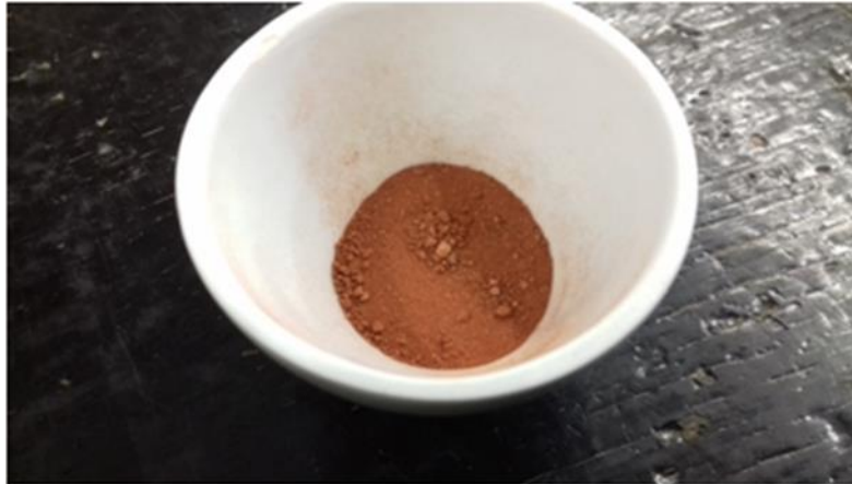
Figura 6. Aspecto que presenta la muestra de suelo tras someterse a 750°C durante 5h (Fuente propia).
