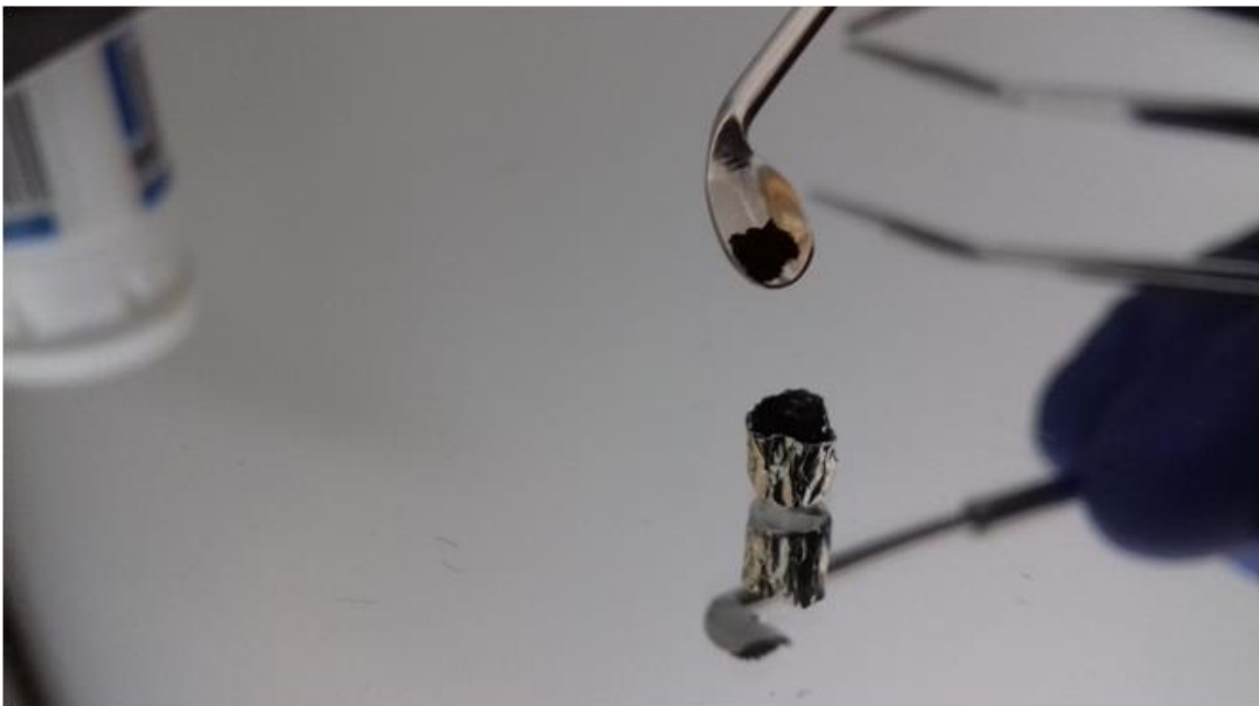
Figura 7. Llenado de la cápsula de Sn con la muestra molida para análisis elemental (Fuente propia).
