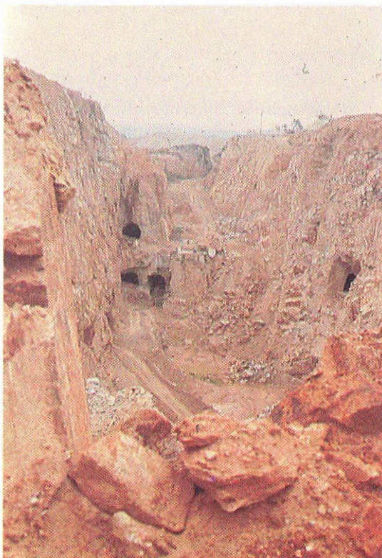
FOTOGRAFÍA 1. Vista mirando hacia el S, de la corta. Frontalmente, se aprecia el filón principal, «filón maestro», casi vertical, obscureciendo el granito encajante por la alteración superficial de los sulfuros, y los túneles que se abrieron para su explotación.
