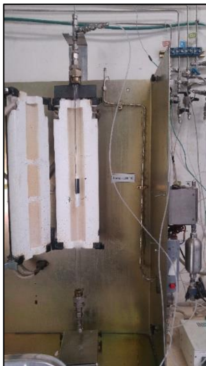
Figura 2-4. Reactor de lecho fijo empleado para la CHR.
