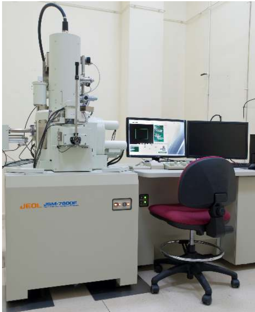
Figura 3.8 Microscopio electrónico de barrido, JEOL JSM 7600F. [31]
