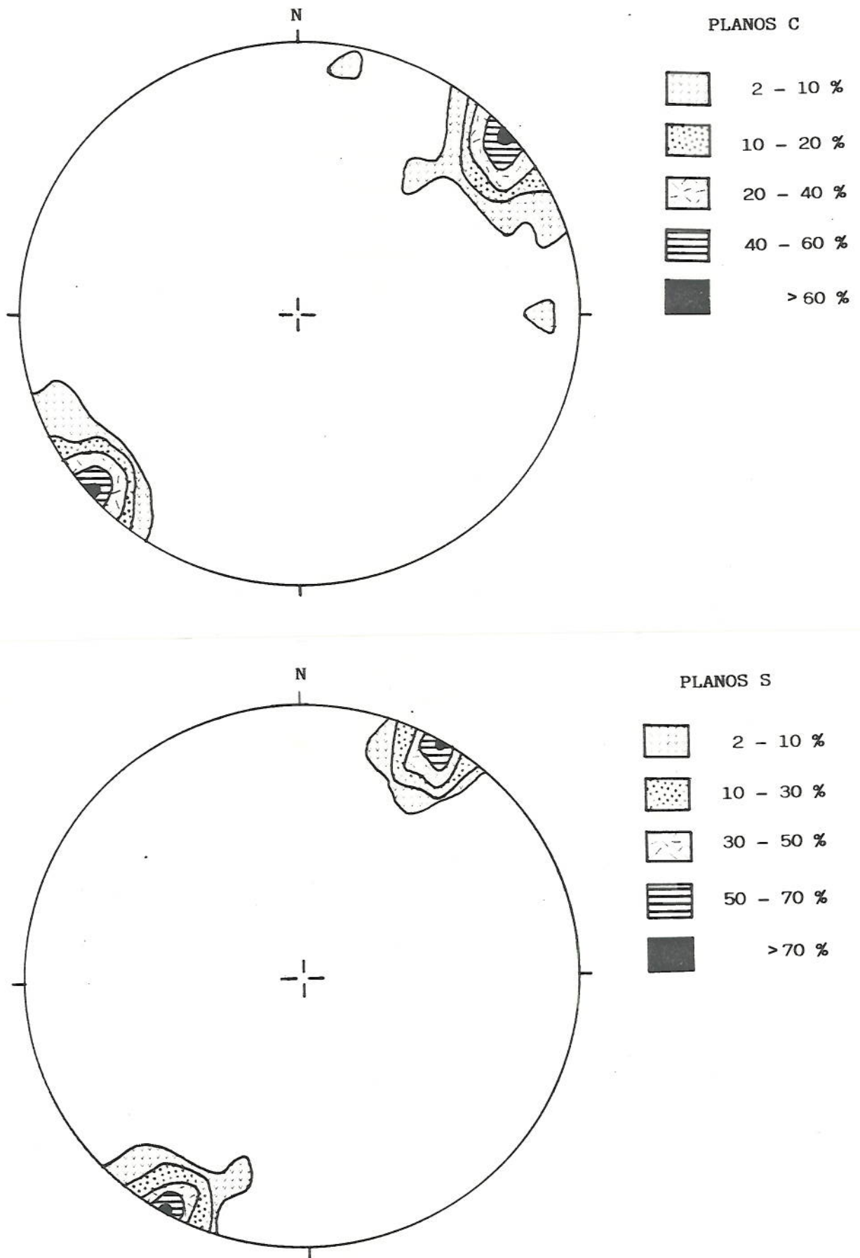
Fig. 74. Disposición de planos C (83 medidas) y S (84 medidas) en el dominio estructural de dos foliaciones del Batolito de Ricobayo (falsilla de Schmidt).
