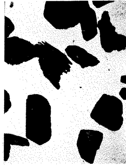
III IV Hiperstenas dentadas junto con alguna prismática.
