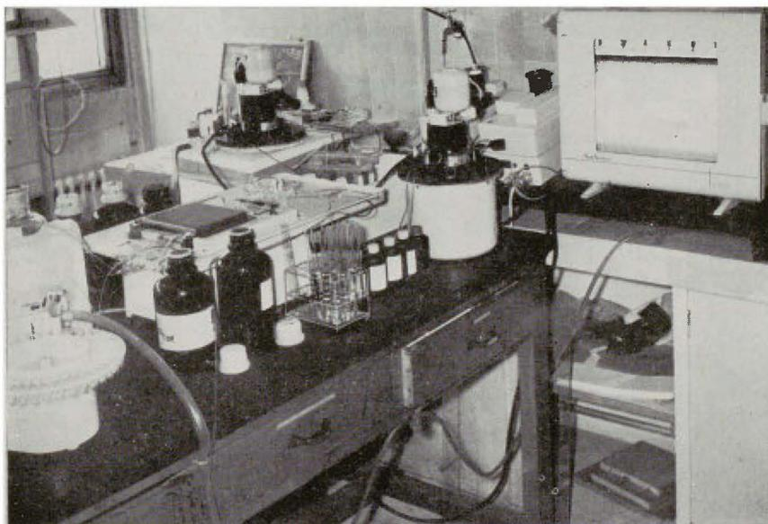
Fig 4. —Sistema autoanalizador Technicon para la determinación de glúcidos reductores
