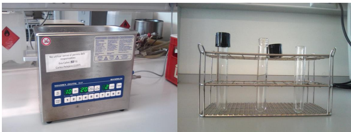
Figura 8. Dispositivo de ultrasonidos SONOREX DIGITAL 10P y tubos de vidrio utilizados en la extracción.
