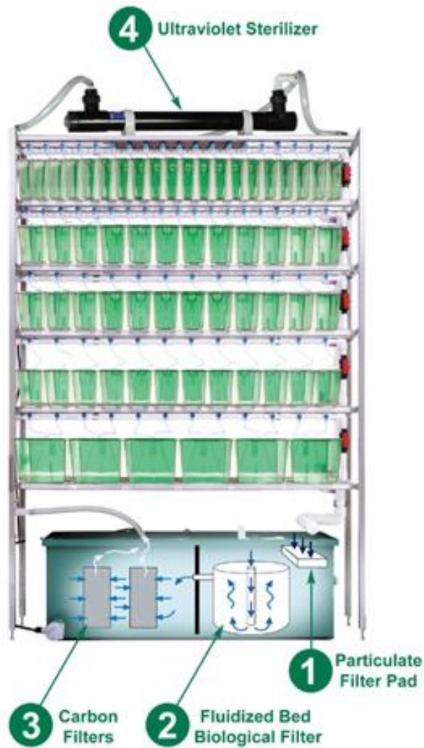
Figura supl 3. Réplica de los racks usados para la cría de los peces cebra en el GBR. Se observa el proceso completo de filtrado del agua que recircula por los conductos para proporcionar agua a las peceras que contienen los individuos.
