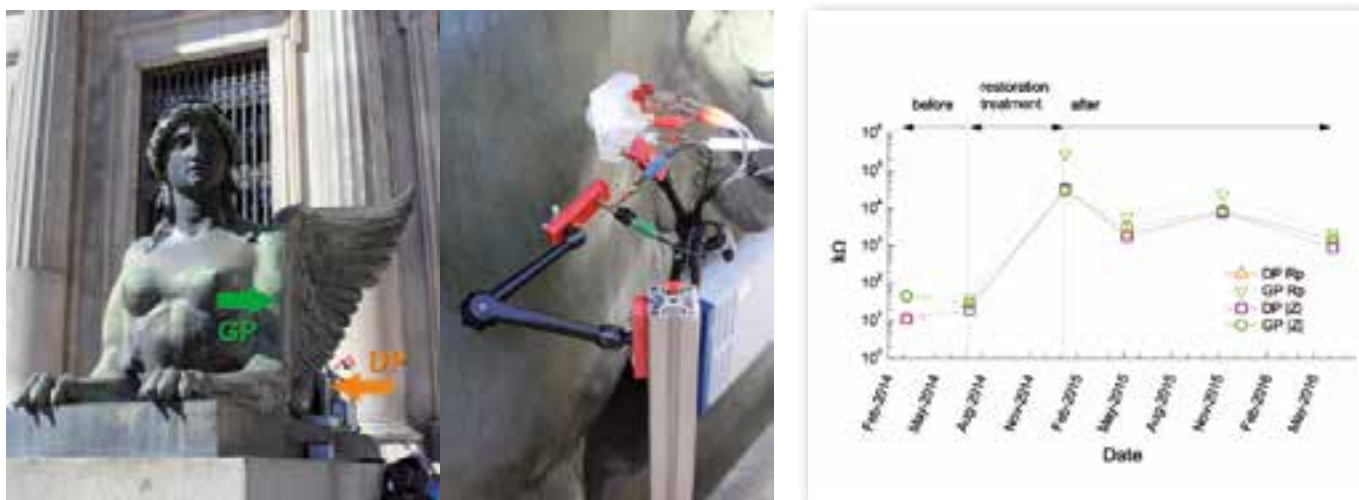
Figura 1. Medidas de impedancia electroquímica (EIS) in-situ utilizando la celda G-PE, para la evaluación de la capacidad protectora de las pátinas, el tratamiento de restauración y evolución con el tiempo del mismo. Esfinges del Museo Arqueológico Nacional.
