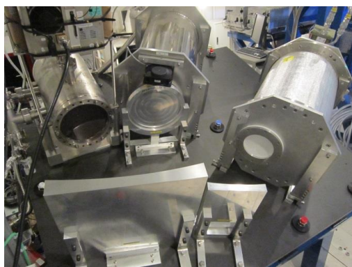
Montaje de cámara de descarga, detector de radiación milimétrica y dispositivo de enfoque en el Observatorio Astronómico de Yebes para estudiar emisiones rotacionales de radicales y moléculas generados en plasmas fríos.
