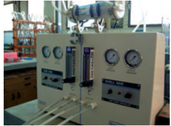
Equipo de membranas líquidas para operaciones en continuo (membranas líquidas soportadas (procesos SLM), extracción no dispersiva (procesos NDSX), extracción no dispersiva con dispersión de la fase de reextracción (procesos EPERT). Liquid membrane equipment for continuous operations: supported liquid membranes (SLM processes), non-dispersive extraction (NDSX processes), non-dispersive extraction with dispersion of reextraction phase (ESPERT processes).
