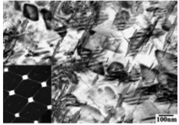
Precipitación de placas de T_1 en una nueva aleación Al-Cu-Li después de deformación plástica severa a elevada temperatura.
