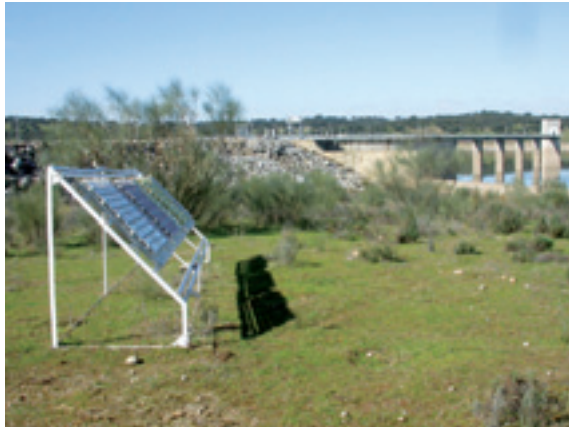
Estación de ensayos de corrosión atmosférica en El Pardo (Madrid). Atmospheric testing station at El Pardo (Madrid).
