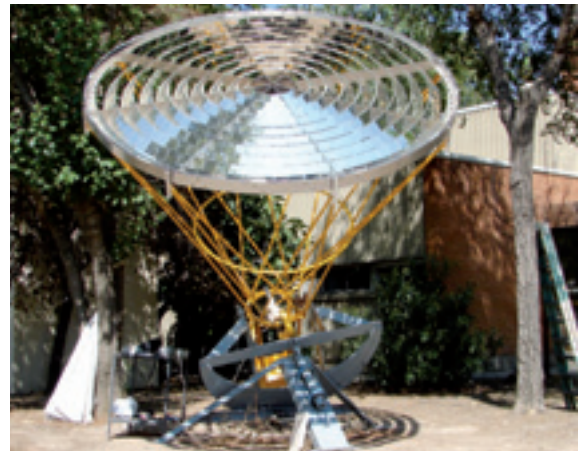
Concentrador de Fresnel de doble reflexión para tratamiento con energía solar concentrada.
