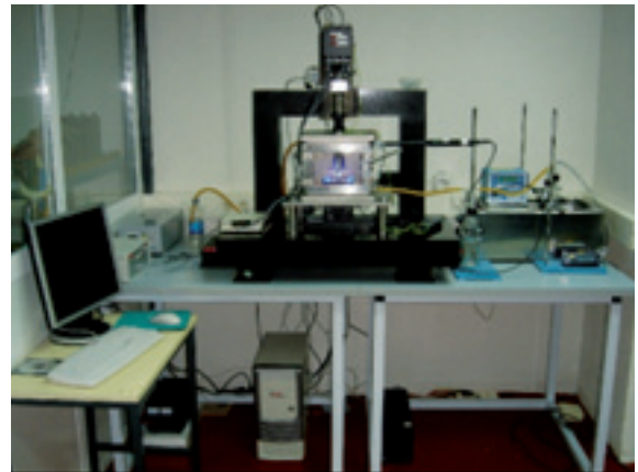
Sonda Electroquímica Kelvin de Barrido (SKP).
