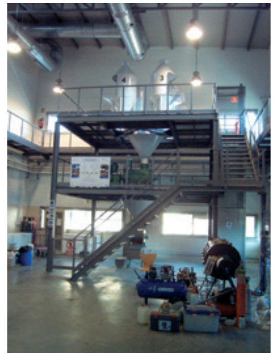
Planta piloto de fabricación de combustibles de residuos (En colaboración con la UCLM) (Patente CENIM: P200002076). Pilot plant for manufacturing of fuel from waste (in collaboration with UCLM). CENIM patent: P200002076.
