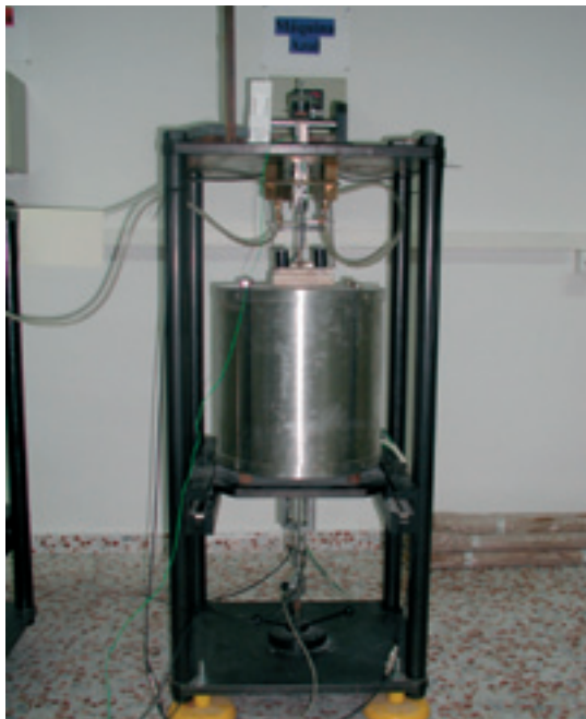
Una de las máquinas de fluencia construidas por MATCOM en las que se ha llevado a cabo este estudio.
