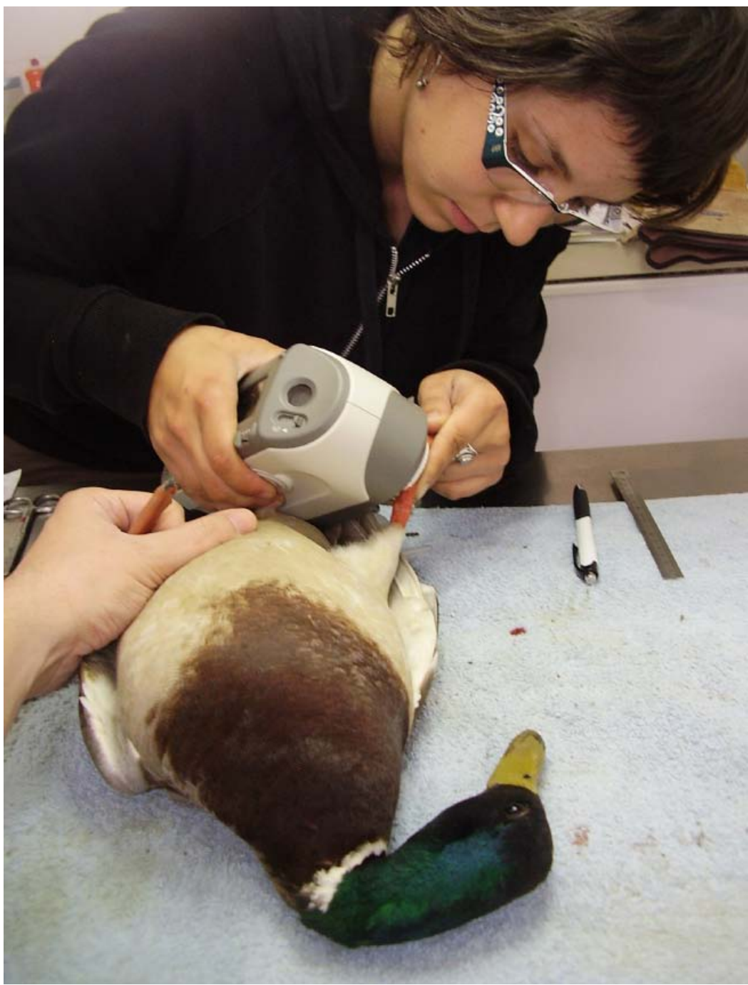
Midiendo la coloración de la pata de un ánade real ( Anas platyrhynchos ) con espectrometría para un estudio de los efectos de plomo en aves. Foto: Rafael Mateo. / Measuring the color of the leg of a Mallard ( Anas platyrhynchos ) with spectrometry to study the effects of lead on birds.
