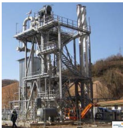
Figura 4. izq) Planta experimental 200 kWt en la CT de La Robla; dcha) Ejemplo de resultados experimentales de captura 'in situ' de CO 2 en la planta de 30 kWt.
