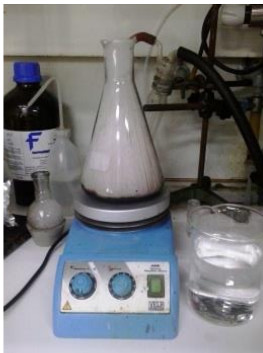
Figura 4.2. Montaje experimental para la reacción de CNH y ácido clorosulfónico con H_2O (reacción exotérmica).
