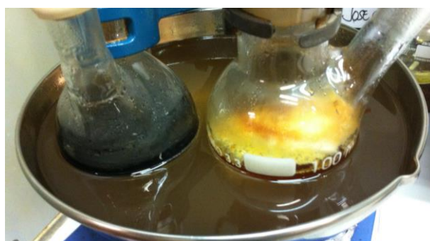
Figura 3.2. Reacción con sales de diazonio a la izquierda reacción de control sin SWCNT y a la derecha reacción de SWCNT con sales de diazonio.
