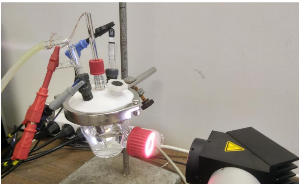
Figura 3.7. Dispositivo experimental para los experimentos fotoelectroquímicos: celda de tres electrodos y lámpara.
