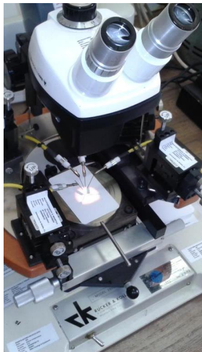
Figura 6.3. Equipo de medida de la resistividad superficial con cuatro puntas. En este caso, se usó la configuración con dos puntas.
