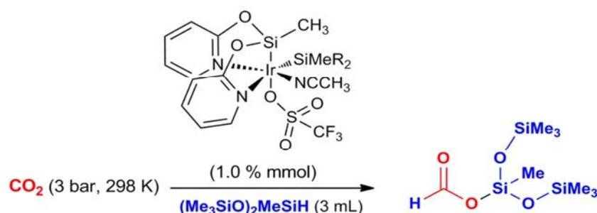
Figura 1.- Esquema sintético del proceso catalítico descrito con indicación de la transformación de  $\text{CO}_2$  en un producto orgánico con potenciales aplicaciones posteriores
