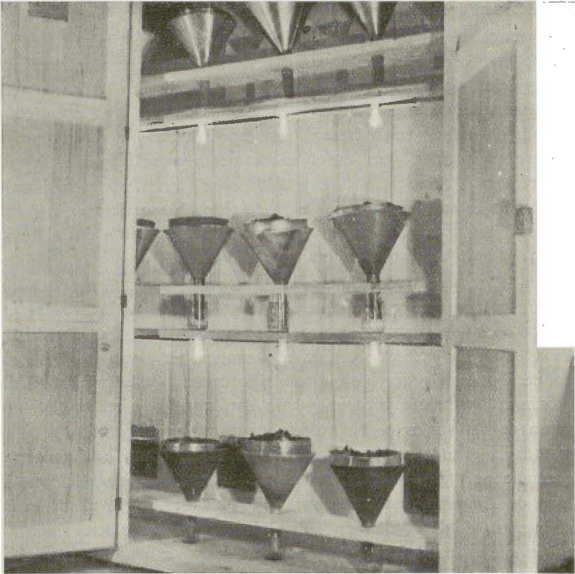
FIG. 1.—Armarío de análisis con aparatos de separación según Berlese. Las muestras y huyen en sentido opuesto a la luz. Se reúnen en los recipientes de temperatura de la habitación, con lo cual los pequeños animales abandonan las muestras y huyen en sentido opuesto a la luz. Se reúnen en los recipientes de cristal debajo de los embudos.
