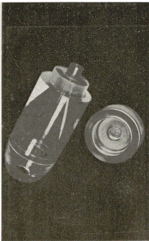
FIG. 3 Base del tubo de centrifugar y cabeza, con el tubito para recoger el sedimento en posición.
